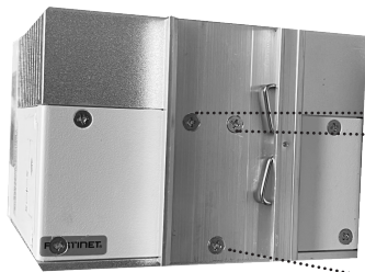
DIN Bracket Installed
